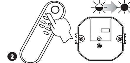
2 Нажать и затем отпустить кнопку «1» пульта управления P-256/8. Зажжется (пульсирующий, а затем постоянный сигнал) красный диод STATUS в светильнике
